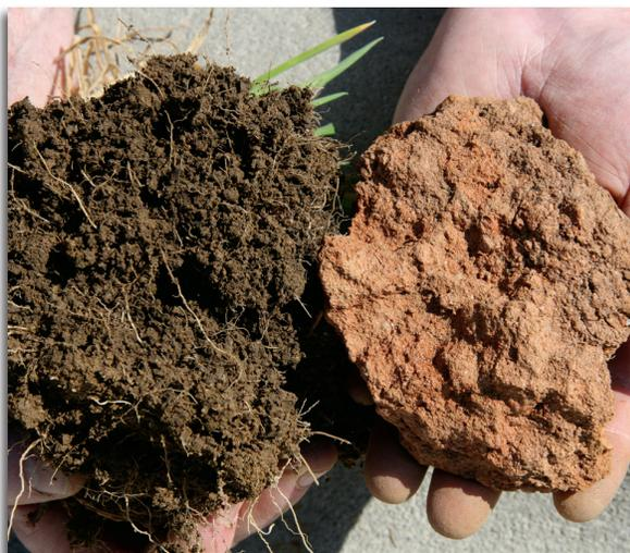
Los suelos desmenuzables (izquierda) tienen más poros y canales que los suelos terronosos (derecha). Los poros y canales permiten que el aire y el agua se muevan dentro del suelo.
