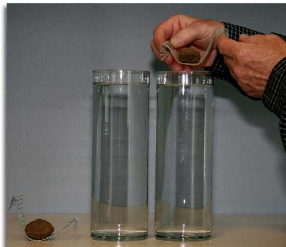
La prueba de disgregación (slake test) demuestra cómo los pegamentos del suelo mantienen unidas las partículas del suelo para resistir la desintegración en partículas individuales.
